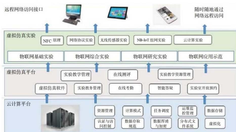
图2 智慧消防物联网虚拟仿真实验项目整体功能架构
